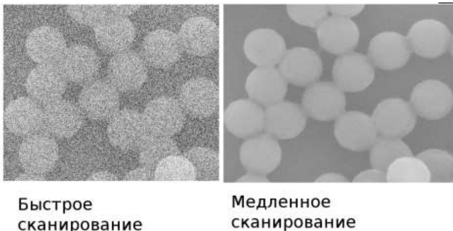
Рис. 17. Влияние скорости сканирования на соотношение сигнал/шум.
